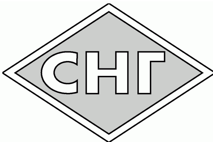
Рисунок 4.4 - Образец опознавательного знака КТС категорий M2 и M3, использующих в качестве топлива сжиженный нефтяной газ (СНГ) или компримированный природный газ (КПГ)
